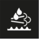
На панели приборов горит желтая сигнальная лампа: пониженный уровень наполнения. Запас хода отображается на панели приборов. Немедленно долейте минимум
