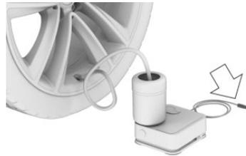
6. Включите компрессор при включенной готовности к работе или к движению.
