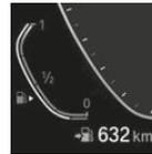
Текущий запас хода в виде числового значения отображается рядом с указателем уровня топлива.
