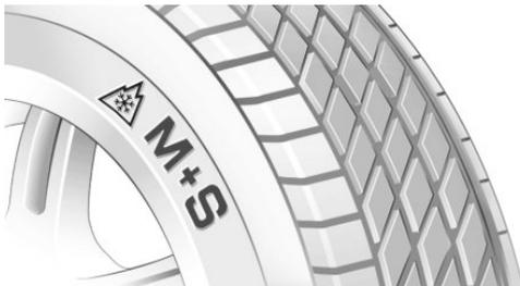
При эксплуатации на зимних дорогах рекомендуется использовать зимние шины.
