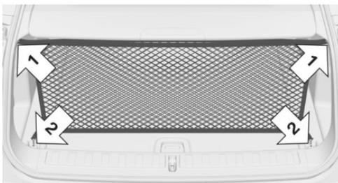
2. Зацепите FlexNet нижними крючками в крепежные проушины, стрелки 2.
