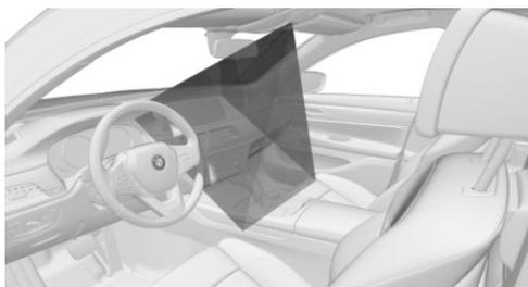
Камера в потолке считывает жесты, выполняемые около центральной консоли на высоте дисплея управления.
