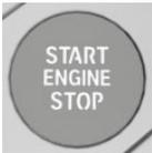
При нажатии на кнопку запуска/остановки двигателя включается или выключается режим готовности к движению.
