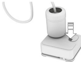
Дайте компрессору поработать в течение максимум 10 минут, чтобы ввести герметик и создать давление в шинах приблизительно 2 бар.
