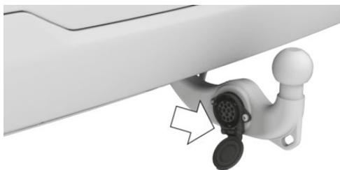
Розетка подключения электрооборудования прицепа находится на тягово-сцепном устройстве.
