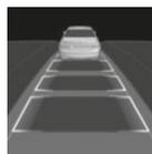
Отсутствие индикации регулировки дистанции, так как нажата педаль акселератора.
