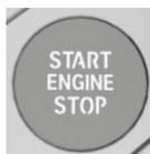
Режим готовности к движению включается с помощью кнопки запуска/остановки двигателя.
