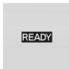
Индикатор на панели приборов сигнализирует, что автоматический Старт/Стоп готов к автоматическому запуску двигателя.
