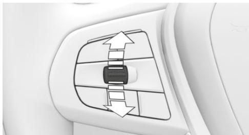
Нажмите на двухпозиционный переключатель в прерванном состоянии один раз вверх или вниз. Система активируется.
