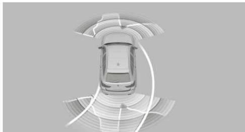
При приближении к объекту на дисплее управления высвечивается сообщение. От дальние препятствия отображаются на дисплее еще до того, как раздастся сигнал.
