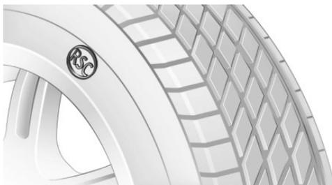
Шины с технологией Runflat обозначены круглым символом с буквами RSC на боковине.
