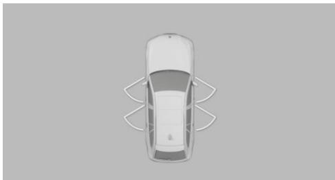
При положении рычага селектора Р отображается максимальный угол раскрытия дверей. Пока автомобиль движется, вместо угла открытия дверей отображаются вспомогательные линии парковки.
