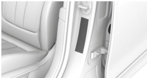
Значения давления воздуха в шинах указаны на стойке двери водителя.
