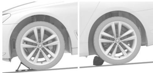
Если смена колеса выполняется на поверхности с небольшим уклоном, подложите клинья или другие подходящие предметы, например камни, под колеса переднего и заднего моста против направления качения.
