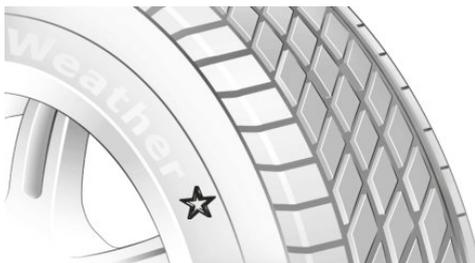
В зависимости от размера шин производитель автомобиля рекомендует определенные марки шин. Марки шины можно определить по звездочке на боковине шины.
