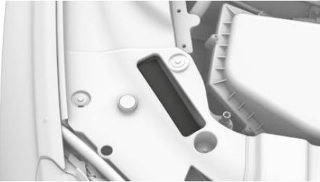
Нанесенный VIN указан в моторном отсеке с правой стороны автомобиля.
