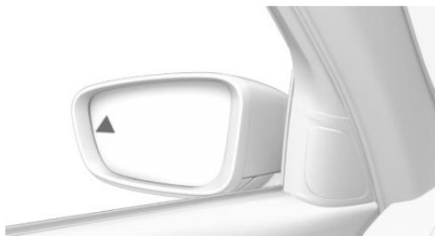
Лампа в наружном зеркале мигает, когда задние датчики распознают автомобили и собственный автомобиль движется назад.
