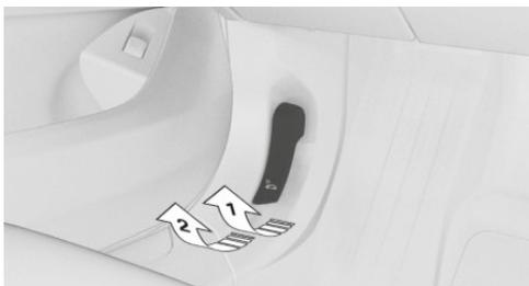
2. После отпускания рычага снова потяните рычаг, стрелка 2. Крышку капота можно открыть.
