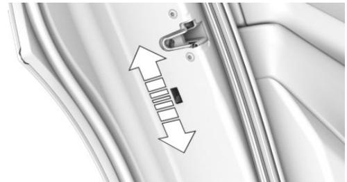
Поднимите вверх предохранительные рычажки на задних дверях.
