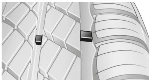
По окружности покрышки распределены индикаторы износа производителя шин высотой не менее 1,6 мм, которые служат индикатором износа рисунка протектора.
