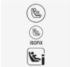
Соответствующим символом отмечены места установки нижних креплений ISOFIX.
