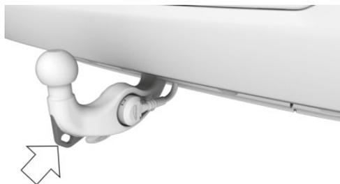
Для крепления предохранительного троса прицепа на тягово-сцепном устройстве предусмотрена специальная проушина.
