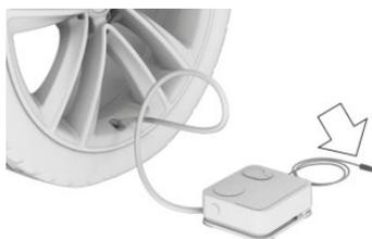
5. С включенной готовностью к эксплуатации или готовностью к движению включите компрессор и дайте ему поработать максимум 10 минут.
