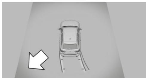
Если датчики распознают автомобили, соответствующая крайняя область в окне системы контроля дистанции при парковке мигает красным цветом.
