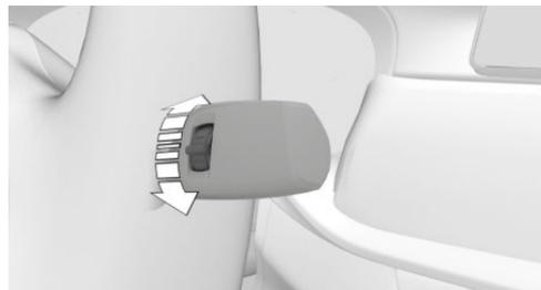
Поверните рифленое колесико, чтобы отрегулировать чувствительность датчика интенсивности дождя.
