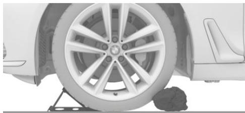
Подложите противооткатные упоры или другие подходящие предметы перед и за колесом, расположенным по диагонали напротив заменяемого колеса.
